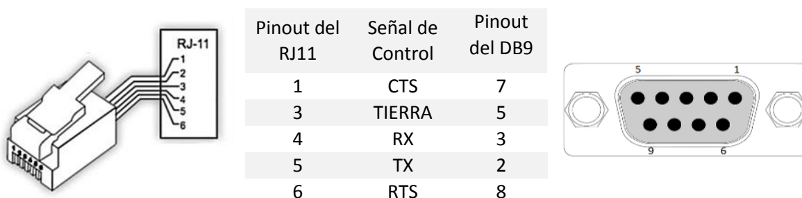
Imagen 10. Conexión entre el cable RJ11 con terminal DB9 macho.
